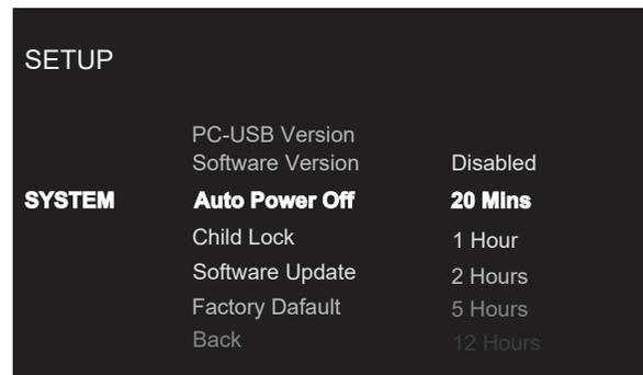
El submenú System (Sistema) del menú Setup (Configuración) permite acceder a las opciones que siguen, seleccionadas resaltando la línea deseada utilizando los botones con flechas  $\wedge/\vee$   $\text{D}$  y pulsando el botón Enter  $\text{K}$  para confirmar. Esta acción muestra las opciones situadas en la parte derecha que permiten cambios. Cambie las opciones utilizando los botones con flechas  $\wedge/\vee$   $\text{D}$  y pulse el botón Enter  $\text{K}$  para confirmar.
