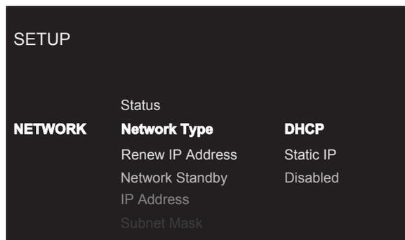
El submenú Network (Red) del menú de Configuración (Setup) proporciona las siguientes opciones, que se seleccionan resaltando la línea deseada utilizando los botones con flechas ^/∨ (D) y pulsando el botón Enter (K). Esta acción muestra las opciones de la parte derecha que permiten cambios. Cambie las opciones mediante los botones con flechas ^/∨ (D) y pulse el botón Enter (K) para confirmar.
