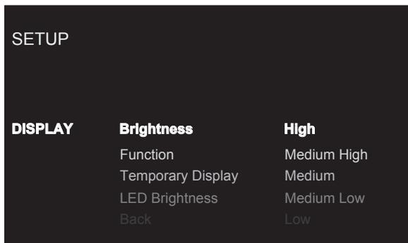
El submenú Display (Visualizador de Funciones) del menú Setup (Configuración) proporciona las opciones que siguen, seleccionadas resaltando la línea deseada con ayuda de los botones con flechas  $\wedge/\vee$   $\text{D}$  y pulsando el botón Enter  $\text{K}$ . Esta acción muestra las opciones situadas en la parte derecha que permiten cambios. Cambie las opciones utilizando los botones con flechas  $\wedge/\vee$   $\text{D}$  y pulse el botón Enter  $\text{K}$  para confirmar.
