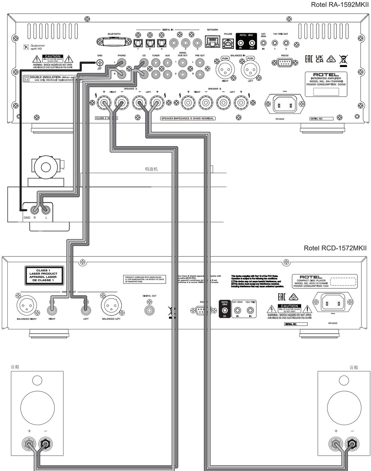
图 4：数字输入和 12V 触发输出连接
