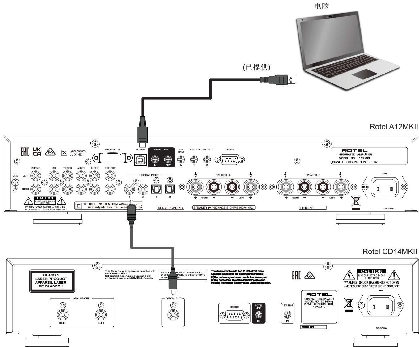
图 5: 12V触发连接
