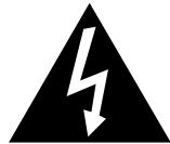
Este símbolo es para alertar al usuario sobre la presencia de tensiones peligrosas no aisladas en el interior del aparato susceptibles de constituir un riesgo de electrocución.
