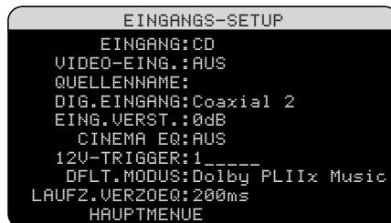
Sie gelangen über das HAUPTMENUE zum EINGANGS-SETUP, in dem die Quelleneingänge konfiguriert werden. Verwenden Sie die UP/DOWN-Tasten, um die gewünschte Zeile anzuwählen. Dieser Bildschirm bietet folgende Einstellmöglichkeiten:
