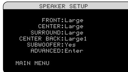
In het "SPEAKER SETUP" menu kunt u de RSX-1058 op de hoogte brengen van uw specifieke luidsprekeropstelling. U bereikt dit menu via het hoofd "MAIN" menu.
