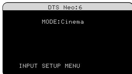
Wanneer u DTS Neo:6 voor een bepaalde ingang in het "INPUT SETUP" menu heeft gekozen, bieden er zich in het submenu nog een paar mogelijkheden aan om de weergavekwaliteit gedurende film en/of muziekweergave te optimaliseren. DTS Neo:6 kan namelijk gebruik maken van mathematische rekentrucs, die een middenkanaal en achterkanalen kunnen berekenen uit twee kanalen (gewoon stereo dus) bronmateriaal.
