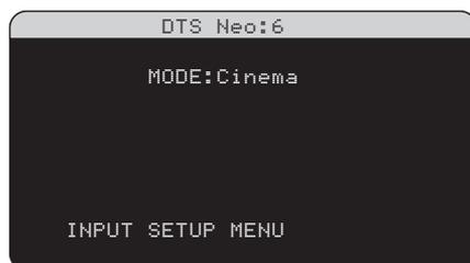
Wird DTS Neo:6 im EINGANGS-SETUP als DFLT. MODUS eingestellt, so gibt es noch weitere Einstellmöglichkeiten und Parameter zur Optimierung der Surrounddecodierung von Musik und Film-Soundtracks. DTS Neo:6 nutzt Algorithmen für die Matrix-Decodierung, um aus 2-Kanal-Quellmaterial Centerkanal- und Surroundkanalinformationen zu gewinnen.
