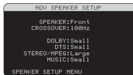
Dans la plupart des cas, la configuration des enceintes décrite auparavant débouche sur un réglage standard global pouvant être utilisé avec tous les modes surround. Cependant, le RSX-1056 offre la possibilité de personnaliser ces réglages avec quatre modes surround différents: Dolby, DTS, Stéréo et Music. Par exemple, vous pouvez régler les modes Dolby et DTS sur 5.1 canaux et le mode Stéréo sur deux enceintes avec ou sans caisson de grave. De plus, ce menu vous permet de sélectionner
