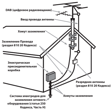
Заземление антенны в соответствии с наставлениями национального электрического Кодекса, раздел 810: «Радио и телевизионное оборудование»
